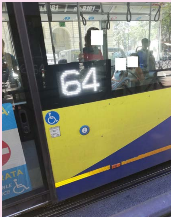
FOTO 22. Avvisatore LED all'esterno del mezzo che “comunica” agli ipovedenti in attesa nell'apposita area della fermata, il “numero e direzione della corsa”
