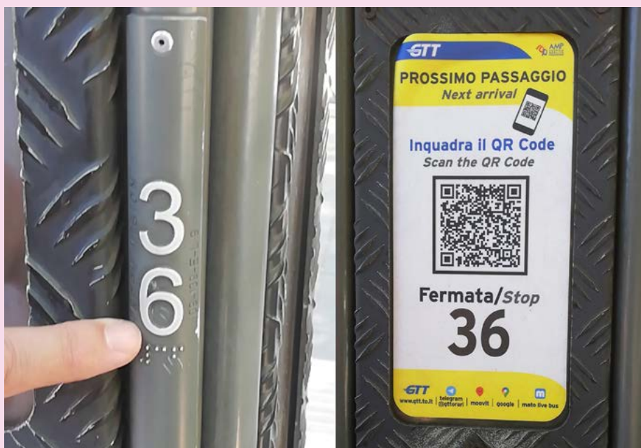
FOTO 19. Palina dotata di etichetta in braille e QR code per informazioni sui passaggi in tempo reale
